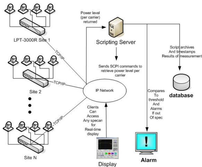
**FIGURE 3: SIMPLE SMS USING SCRIPTED SCPI QUERIES**
