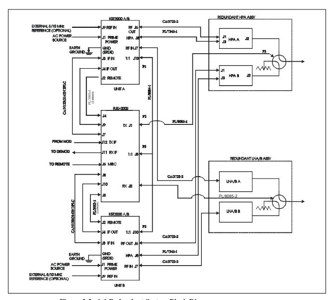
Figure 3-2. 1:1 Redundant System Block Diagram
