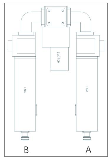
Figure 3-7. Redundant LNA/B Assembly
